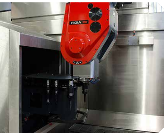
Cambio utensile (utensile più lungo)
