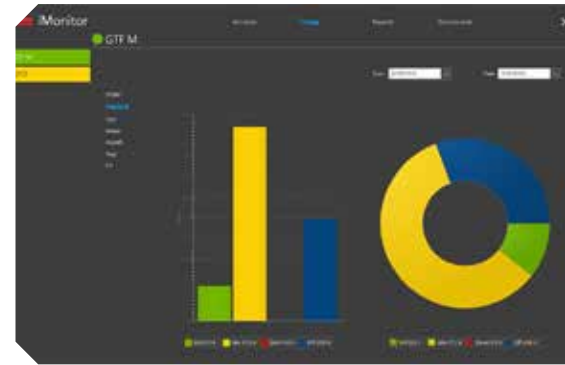
Estados de funcionamiento de la máquina: tiempos totales en un período de tiempo definido por el operador
