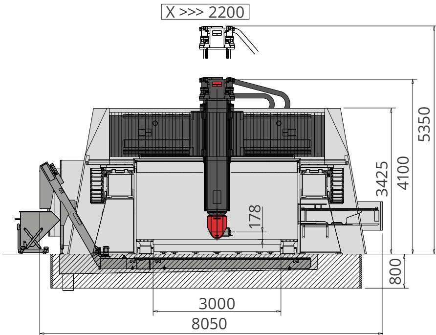
Modello **S** con la tavola portapezzo realizzata in ghisa, indipendente dalle pareti laterali e ancorata alla fondazione, offre la possibilità di adattare la luce sotto testa alle necessità di produzione.
