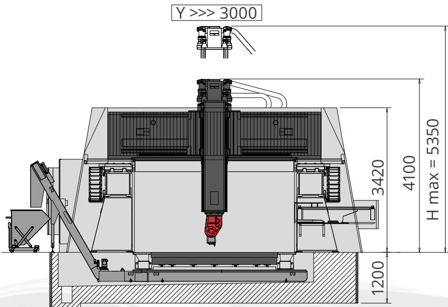
La tavola portapezzo realizzata in ghisa, indipendente dalle pareti laterali e ancorata alla fondazione, offre la possibilità di adattare la luce sotto testa alle necessità di produzione.
