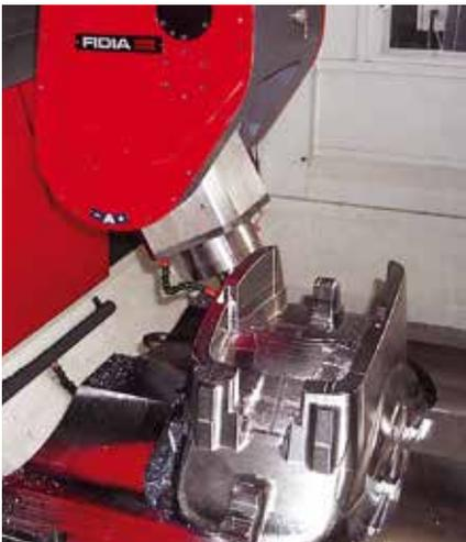
A Y2K consiste na integração de duas máquinas contrapostas trabalhando em diversas áreas de uma única peça ou mais peças simultaneamente.
