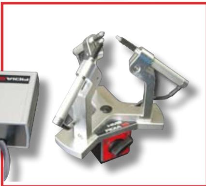
Il sistema HMS è un dispositivo progettato per la misurazione e la qualifica di teste birotative continue e indexate e di tavole rotobasculanti. Dotato di 3 sensori collegati al CNC, è gestito da uno specifico software di misura che, elaborando in tempo reale i dati misurati, è in grado di verificare e correggere gli errori geometrici, la precisione di posizionamento e i parametri RTCP di teste e tavole.
